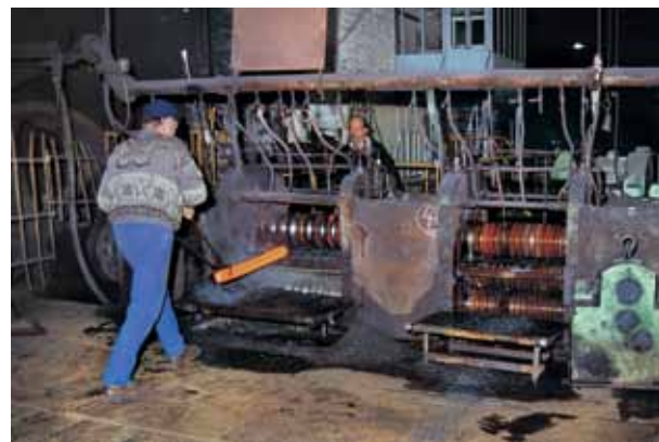
Syam. Les forges, laminage d'une billette d'acier, avec passage en cage de dégrossis.
