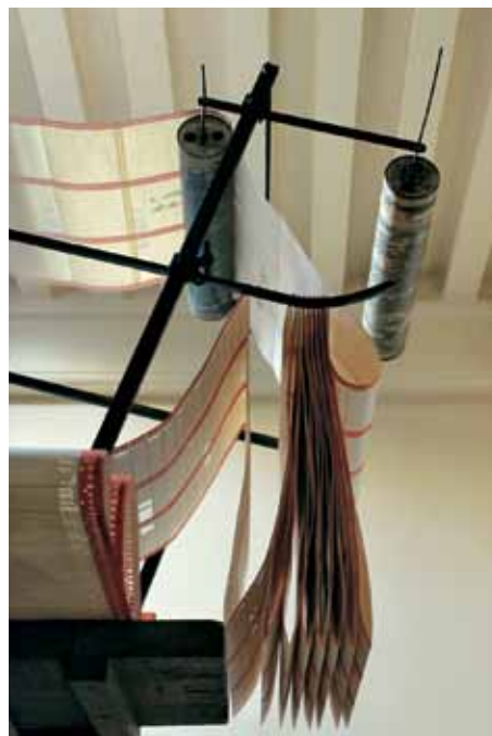
Carte perforée sur mécanique Jacquard, Maison des Canuts.
