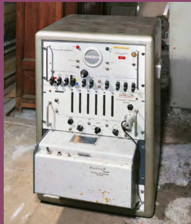
Chronographe totalisateur Ebauches et enregistreur digital Beckmann, années 1960.
