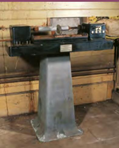
méridien (« méthode œil et oreille »), l'astronome garde l'œil rivé à l'oculaire et active manuellement un « topeur ». Sa tâche est ainsi facilitée et la détermination de l'instant du passage gagne en précision. Le chronographe peut aussi enregistrer la marche des régulateurs astronomiques. Les générations successives de chronographes, de technologies différentes, ont permis d'augmenter considérablement la précision des observations.
