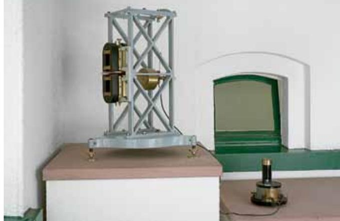
*Le sismomètre Galitzine horizontal, relié au galvanomètre à cadre mobile.*
