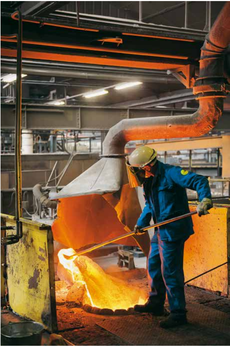
Fonderie Castmetal Colombier. Prélèvement dans un four à induction.
