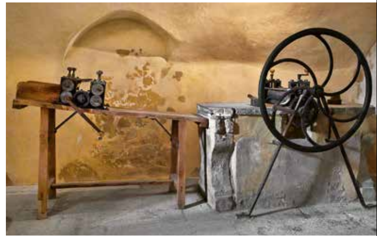
Laminoir à pâte et machine à gaufrer les coudoles.
