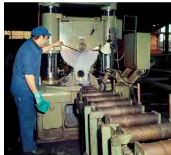
La pièce à étirer est coupée. Usinage à chaud de la soie.
