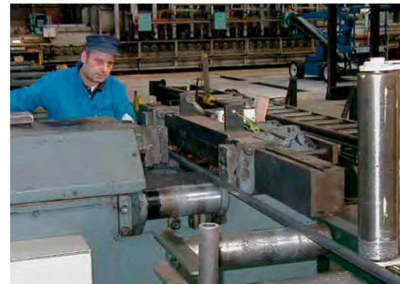
Une opération délicate, le dressage des tubes oblongs à la vue, qui révèle le savoir-faire des ouvriers. 2001.
