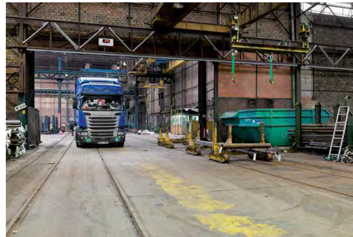
Des passages entre halles dimensionnés pour les camions empruntant la « route intérieure ».
